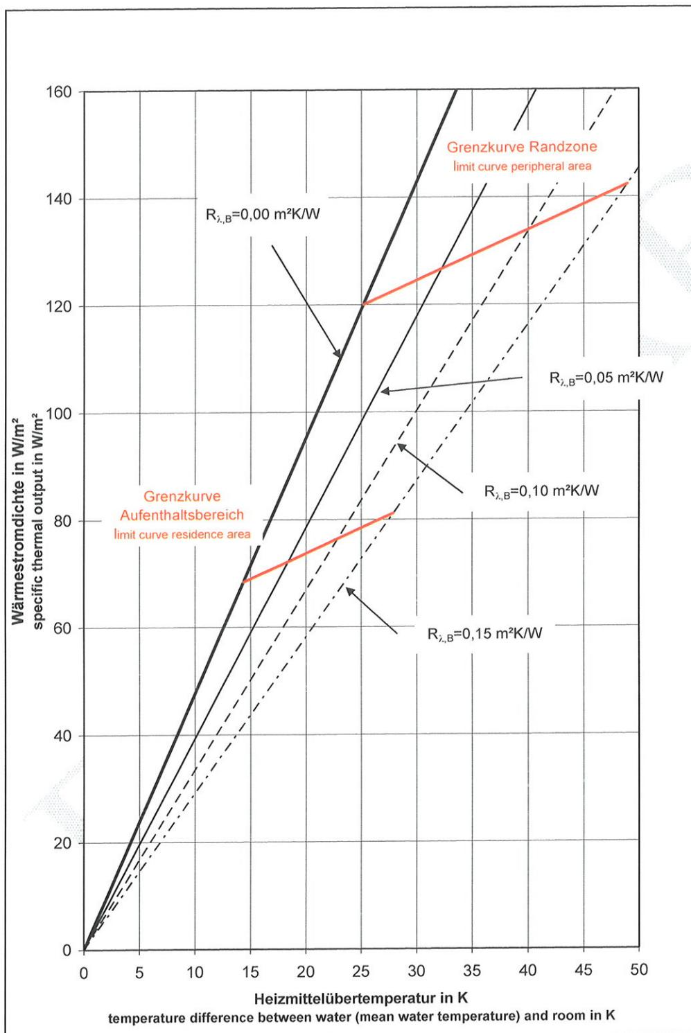
Abbildung 5: Leistungskennlinien Fußbodenheizungssystem
