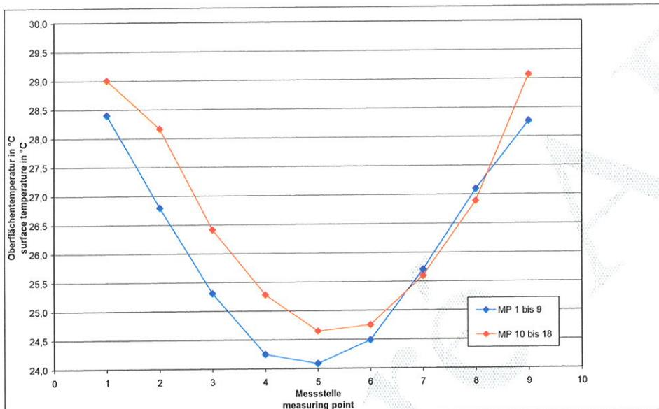
Oberflächentemperaturen mit Fußbodenbelag  $R_\lambda$ , B = 0,14 m<sup>2</sup>K/W
